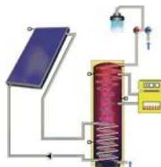
Figure : A5.1 - Système de ballon combiné uniquement pour l'eau chaude
