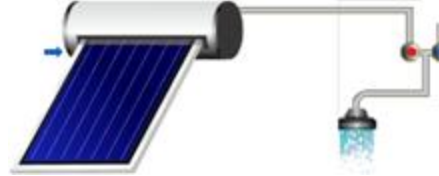
Figure1 : A7.1 – Installation à thermosiphon sans chauffe-eau instantané
