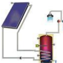
Figure 9.1.3 : A1.2 - Système d'eau chaude avec résistance électrique
