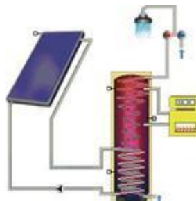
Figure 9.1.13 : A5.1 - Système de ballon combiné uniquement pour l'eau chaude
