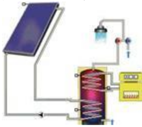
Figure 9.1.1 : A1 - Système d'eau chaude
