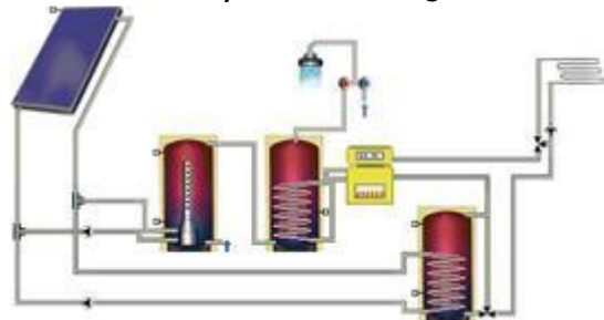
Figure 09.01.11 : A4.1 - Systèmes à deux ballons avec ballon tampon de chauffage et dispositif de charge stratifié
