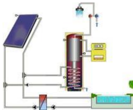
Figure 9.3.8 : B5.3 - Système de piscine et de ballon combiné (réservoir dans réservoir) uniquement pour l'eau chaude
