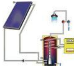
Figure 9.1.2 A1.1 Système d'eau chaude avec dispositif de charge stratifié
