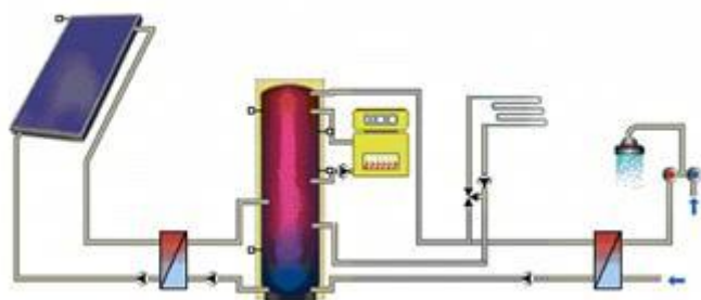
Figure 9.1.30 A18 Installation avec ballon tampon et station d'eau douce
