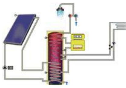
Figure 9.1.17 : A5.5 - Système de ballon combiné pour l'eau chaude et le chauffage
