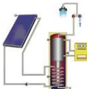
Figure 9.1.15 : A5.3 - Système de ballon combiné (réservoir dans réservoir) uniquement pour l'eau chaude
