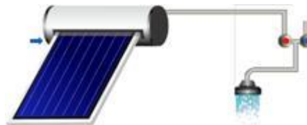
Figure 9.1.21 : A7.1 – Installation à thermosiphon sans chauffe-eau instantané
