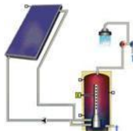
Figure 9.1.4 : A1.3 - Système d'eau chaude avec résistance électrique et dispositif de charge stratifié
