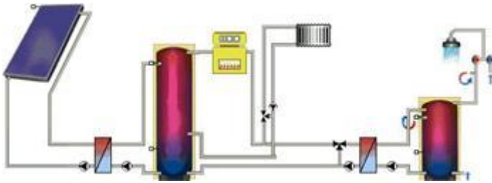
Figure 9.4.4 : C4 - Installation de grande taille pour l'eau chaude et le chauffage avec chauffage d'appoint en continu
