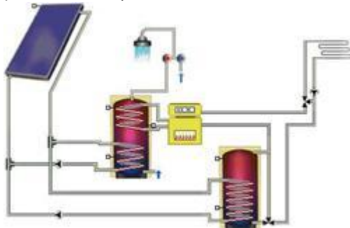
Figure 9.1.7 : A3 - Système d'eau chaude avec ballon tampon de chauffage
