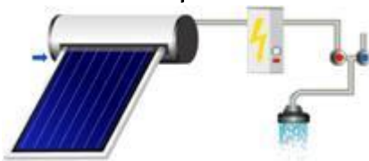
Figure 9.1.20 : A7 – Installation à thermosiphon avec chauffe-eau instantané "Stand alone" (autonome)
